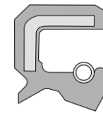
DGS = außen: Gummi und Staubleppe
